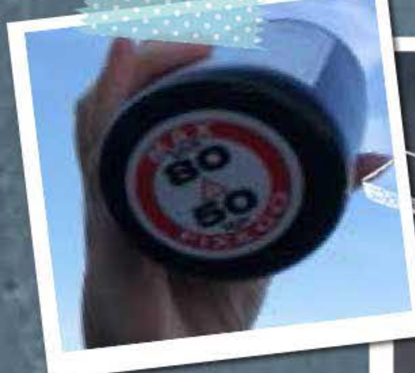
⑤ ホースへバルブに差し込みボトル内の修理剤を 全てタイヤ内に注入してください。 全部入れたら必ずバルブコアを元に戻してください。
